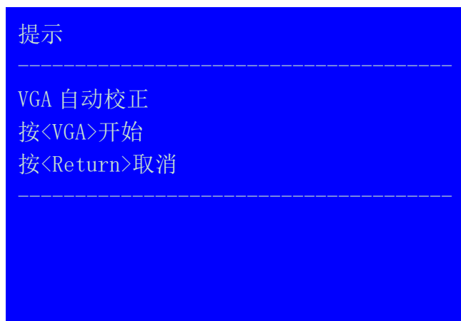
图 6-1b LCD 界面：VGA 自动校正确认菜单
